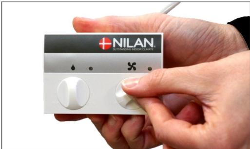
1. Der skal slukkes for aggregatet på betjeningspanelet, inden lågen åbnes.
