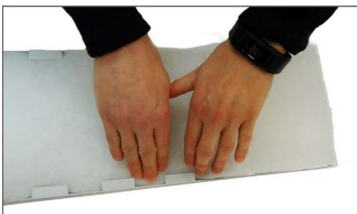
7. Filtermåten klemmes omhyggeligt fast i filterrammen og skubbes godt ud i siderne. Filteret placeres igen i aggregatet med filtermåten opad og gitteret nedad
